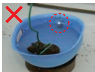
帽体に割れ等がある場合は漏電し、スパークします
