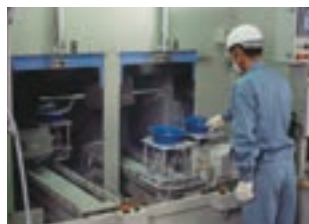
FRP製帽体仕上げ
